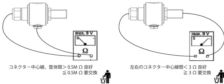
絶縁抵抗試験器（通称 メガ試験器）では検査しないでください。劣化や故障の原因となります。
